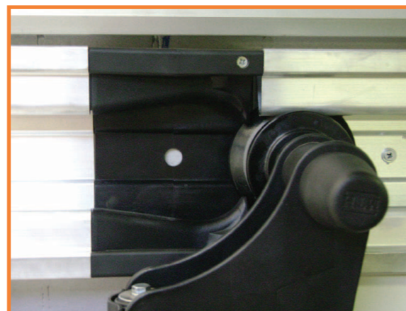
Bloqueo de seguridad al centro del Riel Travel-stop element placed at the center of the sliding track
